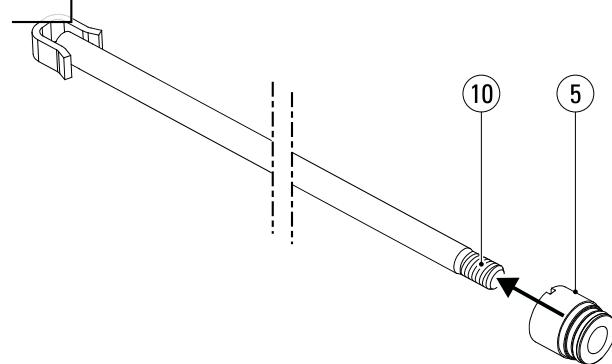
Навинтите новую крышку цилиндра (5) на шток поршня (10).
