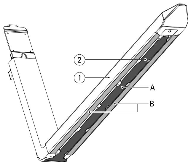
Если поверхность А (вмонтированная темно-серая износостойкая пластина) износится настолько, что будет заподлицо с поверхностью В (светло-серая) или ниже, необходимо заменить насадку (1).
