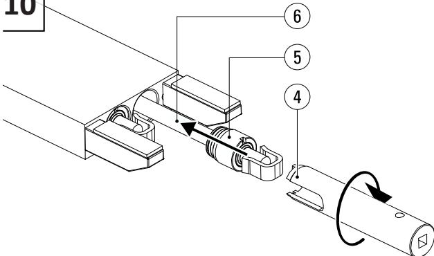
Нанесите компаунд Copaslip<sup>2</sup> на резьбу крышки цилиндра (5). Совместите комплект гидравлики (6) с цилиндром и аккуратно вбейте в штоковую полость молотком. Плотно затяните крышку цилиндра с помощью специального гаечного ключа (4) и ключа с храповым механизмом. Значения моментов затяжки см. в таблице ниже.
