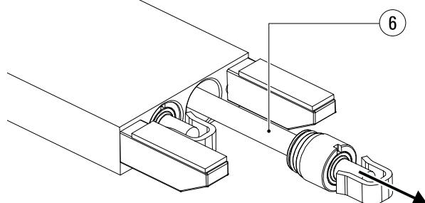
Снимите с лезвия вил весь комплект гидравлики (6), состоящий из поршня, крышки цилиндра и штока.
