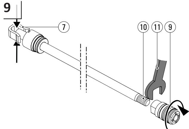
Нанесите фиксатор Loctite 270 на резьбу штока поршня (10)<sup>1</sup>. Зафиксируйте головку штока (7) зажимом (см. шаг 4 в этой главе). Не зажимайте сам шток во избежание повреждений. Очистите резьбу поршня средством Loctite 7063<sup>1</sup>. Затяните поршень (9) динамометрическим ключом с размером зева 24 мм (11) на штоке (10) с моментом 100 нм.
