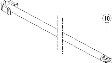
Удалите остатки kleящего вещества с резьбы поршневого штока (10), а затем очистите шток поршня и резьбу (10) с помощью средства Loctite 7063<sup>1</sup>.
