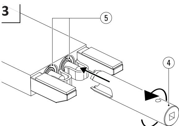
Подставьте под вилы маслосборник. Выкрутите крышки цилиндров (5) с помощью специального гаечного ключа (4) и ключа с храповым механизмом.
