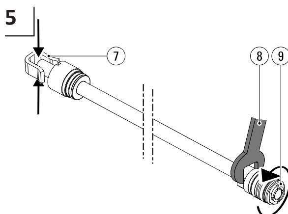
Зафиксируйте головку штока (7) зажимом (см. шаг 4 в этой главе). Не зажимайте сам шток во избежание повреждений. Выкрутите поршень (9) с помощью двухстороннего гаечного ключа с размером зева 24 мм (8). Если поршень не удается выкрутить, нагрейте его горелкой.
