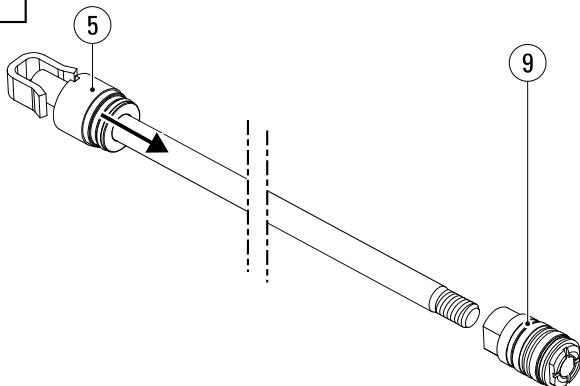
Когда вы снимете поршень (9), можно будет снять крышку цилиндра (5) (если ее нужно заменить).
