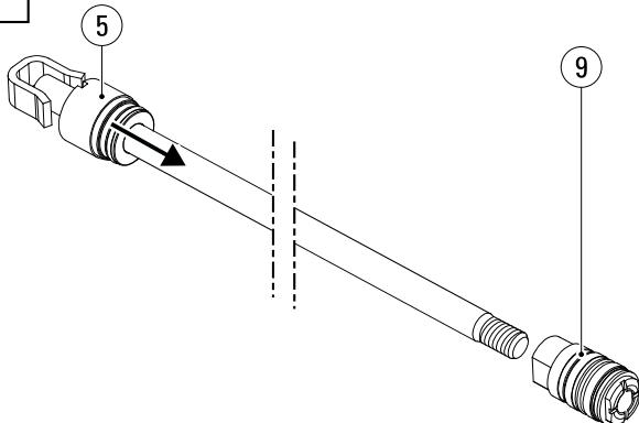
Quando è stato rimosso il pistone (9), è possibile rimuovere la testata (5), nel caso fosse necessario sostituirla.
