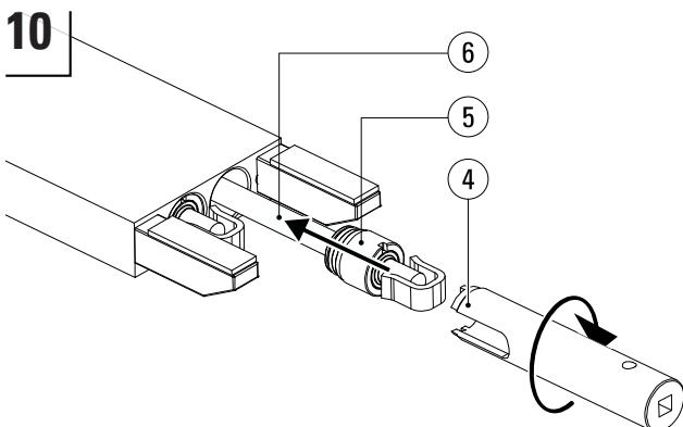
Appicare Copaslip<sup>2</sup> sulla filettatura della testata (5). Allineare il gruppo idraulico (6) al cilindro e utilizzare un martello per inserirlo con cautela nel foro. Serrare con fermezza la testata con la chiave per testata (4) e una chiave dinamometrica. Vedere la tabella sottostante per i valori di coppia.
