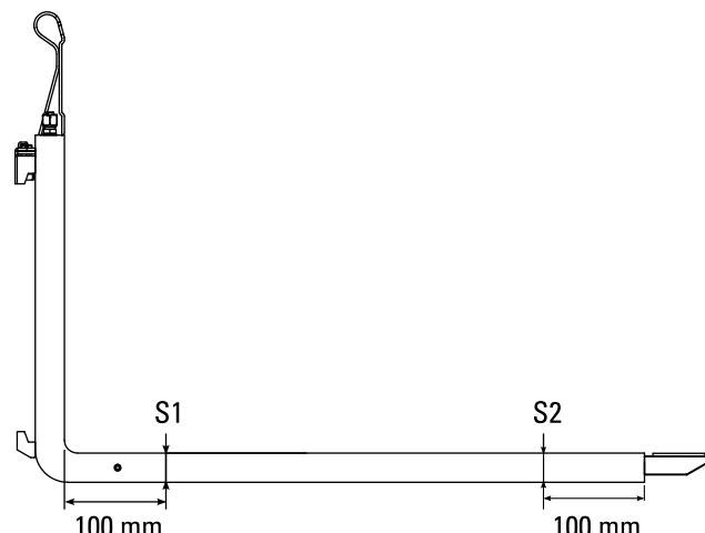
La forza interna deve essere sostituita quando S1 è del 5% più sottile di S2. Vedere il punto 7 della manutenzione periodica.
