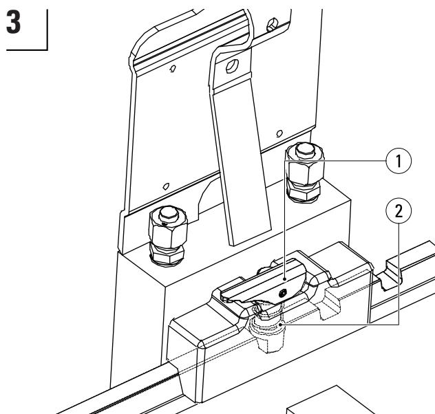
Assicurarsi che ciascun perno di bloccaggio dell'unità KOOI-REACHFORKS® (2) si innesti in una delle tacche della slitta. Utilizzare il fermo (1) prima di utilizzare l'attrezzatura.
