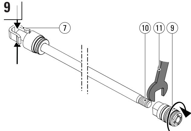
Appicare Loctite 270 sulla filettatura (10) della biella<sup>1</sup>. Per evitare possibili danni, fissare la biella alla relativa estremità (7), non sulla biella stessa (vedere il passaggio 4 in questo capitolo). Pulire la filettatura del pistone con Loctite 7063<sup>1</sup>. Utilizzare una chiave dinamometrica 24 (11) per serrare il pistone (9) sulla biella (10) a una coppia di 100 Nm.
