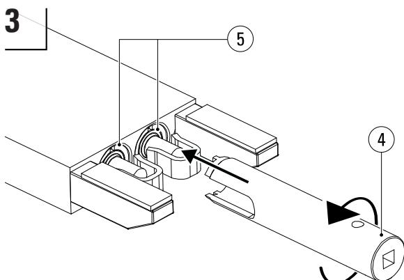
Posizionare una vaschetta di raccolta sotto la forca. Svitare le testate (5) con una chiave per testata (4) e un cricchetto.
