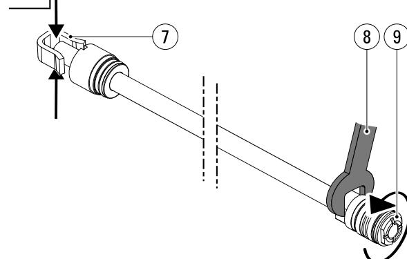
Per evitare possibili danni, fissare la biella alla relativa estremità (7), non sulla biella stessa (vedere il passaggio 4 in questo capitolo). Con una chiave fissa n. 24 (8), allentare il pistone (9). Se non si riesce ad allentare il pistone, riscaldare il pistone con un bruciatore.
