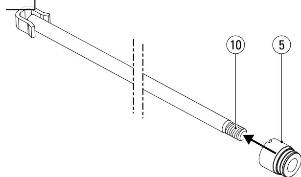
Schieben Sie den (neuen) Zylinderkopf (5) auf die Kolbenstange (10).
