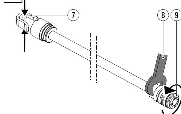
Klemmen Sie die Kolbenstange am Stangenkopf (7) fest und nicht an der Kolbenstange selbst, um Schäden zu vermeiden (siehe Schritt 4 in diesem Kapitel). Verwenden Sie einen Doppelmaulschlüssel der Größe 24 (8), um den Kolben (9) zu lösen. Wenn der Kolben nicht gelöst werden kann, erhitzen Sie den Kolben mit einem Brenner.
