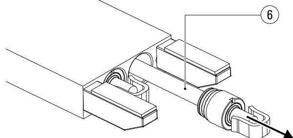
Ziehen Sie die gesamte Hydraulikbaugruppe (6) bestehend aus Kolben, Zylinderkopf und Kolbenstange aus der Gabel.
