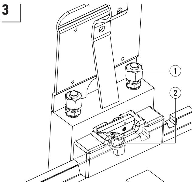
Stellen Sie sicher, dass alle KOOI-REACHFORKS®-Arretierbolzen (2) in jeweils eine Kerbe des Gabelträgers hineingleiten. Verwenden Sie vor der Inbetriebnahme eine Arretierung (1).
