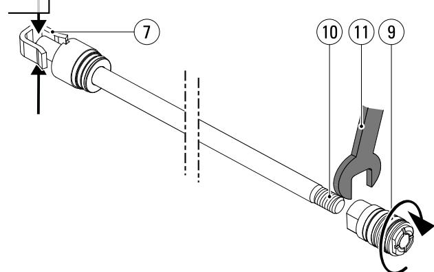
Tragen Sie Loctite 270 auf das Gewinde (10) der Kolbenstange<sup>1</sup> auf. Klemmen Sie die Kolbenstange am Stangenkopf (7) fest und nicht an der Kolbenstange selbst, um Schäden zu vermeiden (siehe Schritt 4 in diesem Kapitel). Reinigen Sie das Kolbengewinde mit Loctite 7063<sup>1</sup>. Verwenden Sie einen Drehmomentschlüssel der Größe 24 (11), um den Kolben (9) mit einem Drehmoment von 100 Nm an der Kolbenstange (10) zu befestigen.
