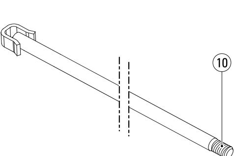
Entfernen Sie verbleibende Kleberreste vom Kolbenstangengewinde (10) und reinigen Sie anschließend die Kolbenstange und das Gewinde (10) mit Loctite 7063<sup>1</sup>.
