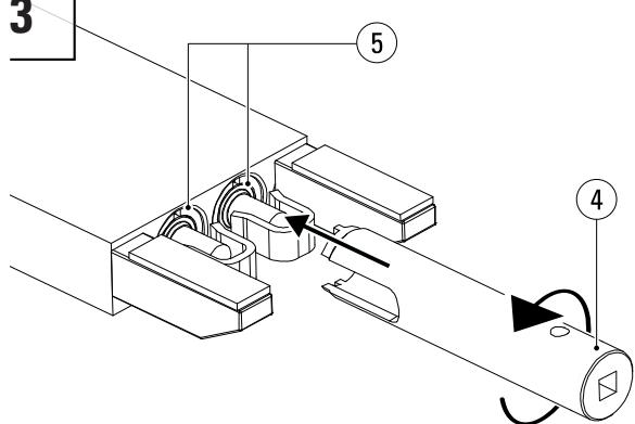
Stellen Sie eine Tropfwanne unter die Gabel. Lösen Sie die Schrauben am/an den Zylinderkopf/Zylinderköpfen (5) mithilfe eines Zylinderkopfschlüssels (4) und einer Ratsche.
