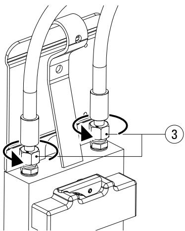
Lösen Sie etwas die Schlauchkupplungen (3), sodass die Kolben beim Ausbauen der Hydraulikteile kein Vakuum erzeugen.
