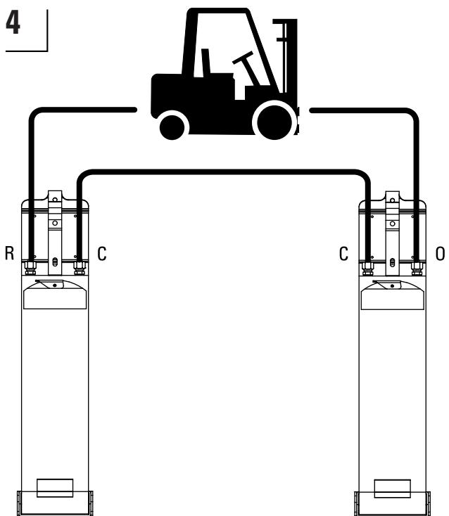
Schließen Sie die KOOI-REACHFORKS® am Hydrauliksystem an.
