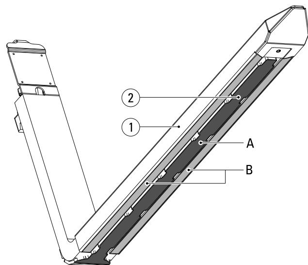
Wenn die Fläche A (dunkelgrau, integrierte Verschleißplatte) so verschlissen ist, dass sie sich mit der Fläche B (hellgrau) auf gleicher Höhe oder sich unterhalb dieser Fläche befindet, muss die Hülse (1) ausgetauscht werden. Siehe Punkt 4 des Wartungsplans.
