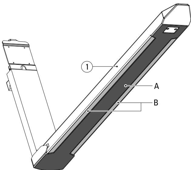
Lorsque la surface A (gris foncé, plaque d'usure intégrée) est usée au point qu'elle est au moins au même niveau que la surface B (gris clair), il faut remplacer le fourreau (1). Voir point 4 du programme d'entretien.
