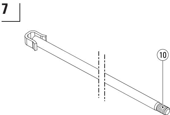
Enlever tout résidu de colle restant du filetage de la tige de piston (10) puis nettoyer la tige de piston et le filetage (10) au moyen de Loctite 7063<sup>1</sup>.
