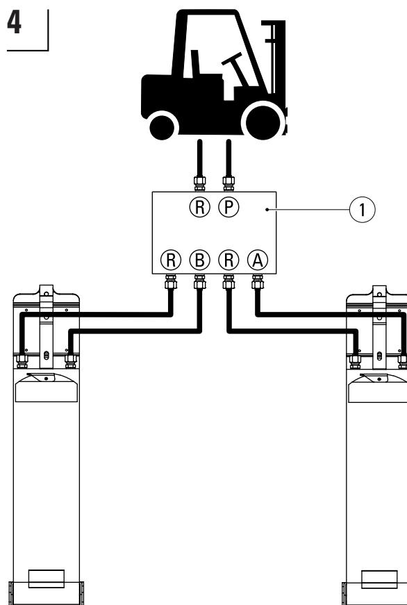
Raccorderer les fourches KOOI-REACHFORKS® au système hydraulique via le diviseur de débit (1).
