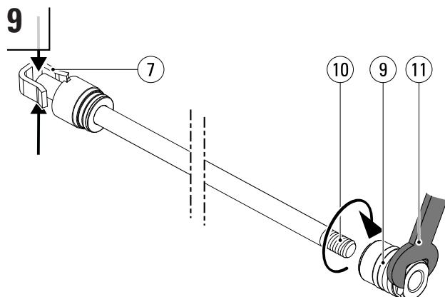
Appliquer le Loctite 270 sur le filetage (10) de la tige de piston<sup>1</sup>. Serrer la tige de piston à l'aide d'une pince à l'extrémité de la tige (7) et non sur la tige de piston elle-même afin d'éviter de la détériorer (voir étape 4 dans cette section). Nettoyer le filetage du piston avec du Loctite 7063<sup>1</sup>. Employer une clé dynamométrique de 19 ou 24 (11) pour serrer le piston (9) sur la tige de piston (10) au couple de 70 Nm.
