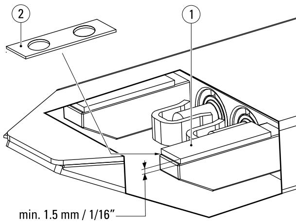
L'épaisseur des bandes d'usure (1) ne peut être inférieure à 1,5 mm (1/16"). Lorsque les bandes d'usure (1) ont atteint cette épaisseur, les remplacer ou combler avec des cales d'espacement (2) (Art. N° RE0092002). Voir point 3 du programme d'entretien.
