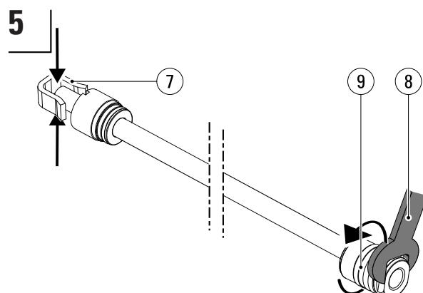
Serrer la tige de piston à l'aide d'une pince à l'extrémité de la tige (7) et non sur la tige de piston elle-même afin d'éviter de la détériorer (voir étape 4 dans cette section). Utiliser une clé plate de 19 ou de 24 (8) pour desserrer le piston (9). Si le piston ne peut être desserré, le chauffer à l'aide d'un chalumeau.
