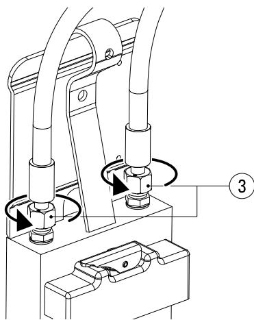
Dévisser légèrement les raccords de tuyau (3) afin que les pistons ne créent pas de vide au moment de retirer les parties hydrauliques.
