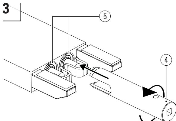
Placer un bac récepteur sous la fourche. Dévisser la/les culasse(s) (5) à l'aide d'une clé de culasse (4) et d'un cliquet.
