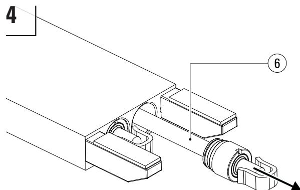
Retirer tout l'ensemble hydraulique (6) composé du piston, de la culasse et de la tige de piston de la fourche.
