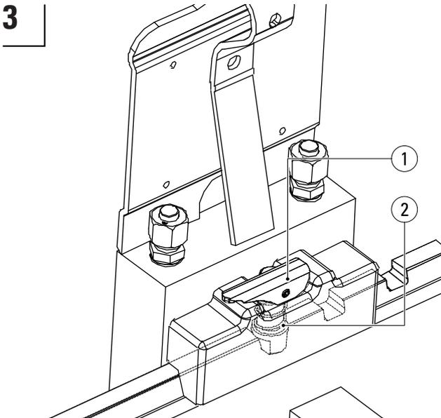
Asegúrese de que las clavijas de bloqueo (2) de cada una de las KOOI-REACHFORKS® queden encajadas en una de las ranuras del portahorquillas. Utilice el pestillo (1) antes de accionarlas.
