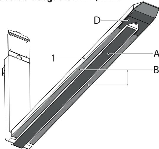
Cuando la superficie A (gris oscuro, placa de desgaste soldada) está desgastada hasta el punto de quedar al mismo nivel o por debajo de la superficie B (gris claro), es necesario sustituir la placa de desgaste soldada (A). La placa de desgaste D (placa de desgaste opcional) debe reemplazarse cuando se haya desgastado 3 mm o más. Para más información sobre las placas de desgaste soldadas, póngase en contacto con su proveedor de horquillas. Véase el punto 4 del programa de mantenimiento.
