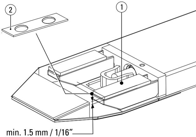
El grosor de las tiras de desgaste (1) no puede ser inferior a 1,5 mm (1/16"). Cuando las tiras de desgaste (1) se hayan desgastado hasta alcanzar este grosor, sustitúyalas o rellene el espacio con separadores (2) (n.º art. RE0092002). Ver el punto 3 del Programa de Mantenimiento.
