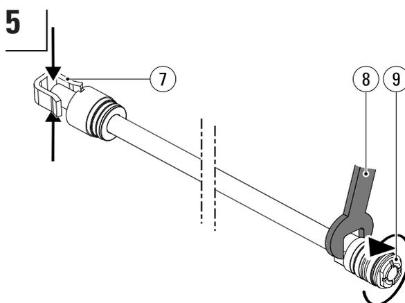
Para evitar que se produzcan daños, sujete con una abrazadera la varilla del pistón por el extremo de la varilla (7), no por la varilla del pistón (véase el paso 4 de este capítulo). Utilice una llave de boca fija abierta de 19 mm (8) para aflojar el pistón (9). Si no logra aflojar el pistón, caliéntelo con un quemador.
