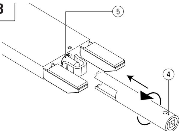
Coloque una bandeja debajo de la horquilla. Desatornille el cabezal (5) del cilindro usando una llave para cabezales de cilindros (4) y una carraca.
