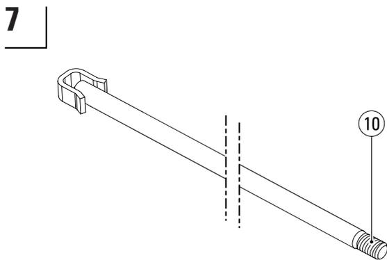
Retire cualquier residuo de adhesivo restante de la rosca (10) de la varilla del pistón, y limpie la varilla y la rosca (10) del pistón con Loctite 7063<sup>1</sup>.
