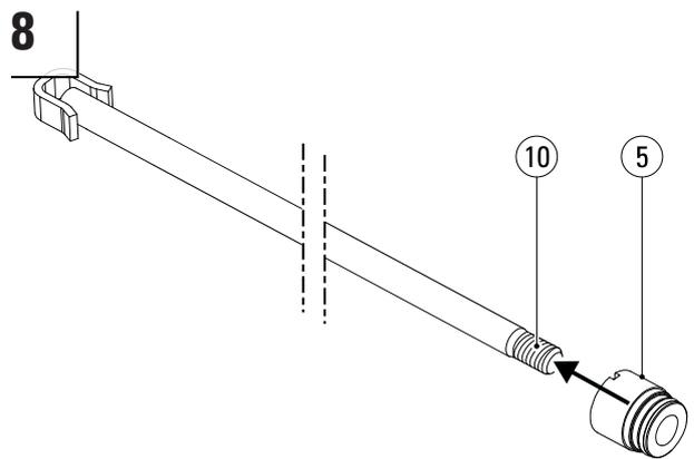
Coloque el (nuevo) cabezal (5) del cilindro deslizando por la varilla del pistón (10).
