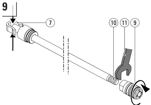
Aplique Loctite 270 a la rosca (10) de la varilla del pistón<sup>1</sup>. Para evitar que se produzcan daños, sujete con una abrazadera la varilla del pistón por el extremo de la varilla (7), no por la varilla del pistón (véase el paso 4 de este capítulo). Limpie la rosca del pistón con Loctite 7063<sup>1</sup>. Utilice una llave dinamométrica de 19 mm (11) para apretar el pistón (9) a la varilla (10) del pistón hasta alcanzar un par de apriete de 40 Nm.
