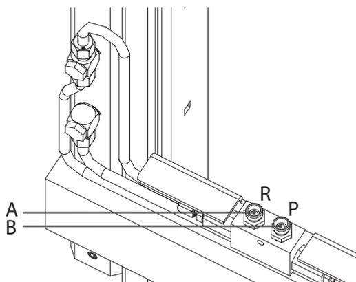
Connecter le système hydraulique du chariot élévateur aux raccords A + B de la MHEH.
