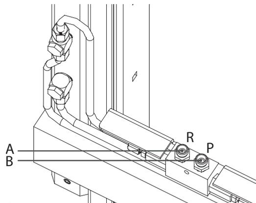
Conecte el sistema hidráulico de la carretilla elevadora a los puertos A + B de la MHEH.
