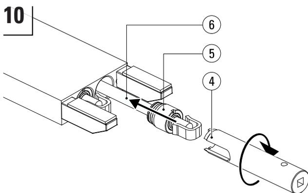
Enduire le filetage de la culasse (5) de Copaslip<sup>2</sup>. Aligner l'ensemble hydraulique (6) avec le cylindre et taper prudemment au marteau pour le faire entrer dans l'alésage. Bien serrer la culasse à l'aide de la clé de culasse (4) et d'une clé dynamométrique. Voir le tableau ci-dessous pour les couples de serrage de référence.
