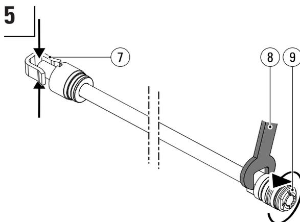
Serrer la tige de piston à l'aide d'une pince à l'extrémité de la tige (7) et non sur la tige de piston elle-même afin d'éviter de la détériorer (voir étape 4 dans cette section). Utiliser une clé plate de 24 (8) pour desserrer le piston (9). Si le piston ne peut être desserré, le chauffer à l'aide d'un chalumeau.
