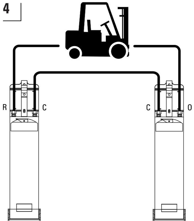
Raccorder les fourches KOOI-REACHFORKS® au système hydraulique.
