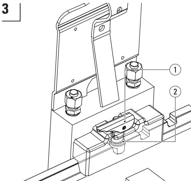
Vérifier que chaque goupille de sûreté des fourches KOOI-REACHFORKS® (2) retombe dans l'un des crans du tablier porte-fourche. Mettre le cliquet (1) avant d'utiliser les fourches.
