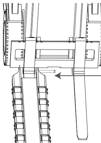
Remettez l'axe en acier en place pour fixer les rallonges à rouleaux pour dents de fourche sur le chariot élévateur. Remettez la goupille de verrouillage à l'extrémité de l'axe en acier.
