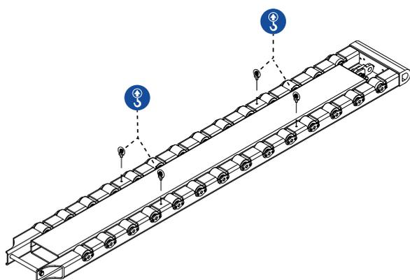
Insérez quatre anneaux de levage (M12) dans les trous filetés aux emplacements indiqués ci-dessus. Attachez les sangles de levage aux anneaux de levage pour soulever les rallonges à rouleaux pour dents de fourche.
