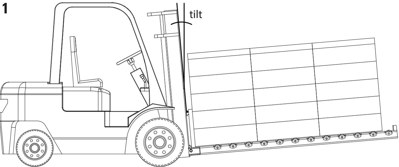
Le mât du chariot élévateur doit être incliné de plusieurs degrés vers l'arrière de manière à ce que la charge ne roule pas.
