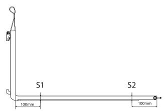
La forca non risulta più conforme ed è necessario sostituirla quando lo spessore di S1 è inferiore del 5% rispetto a S2. Vedere il punto 4 del Piano di manutenzione.
