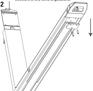
Estrarre il finecorsa e le tre bussole di serraggio con cui il finecorsa è fermato alla forca interna.
