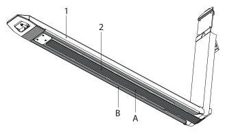
Quando la superficie A (grigio scuro) è usurata in modo tale da trovarsi in linea o in posizione inferiore alla superficie B (grigio chiaro), è necessario sostituire la guaina antiusura (2). Sostituire la camicia se sono presenti tracce di usura sul lato inferiore della camicia (2). Vedere il punto 4 del Piano di manutenzione.
